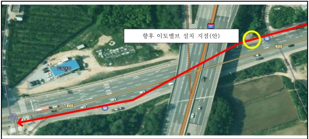
【그림 3.4】 이토밸브 추가 설치지점 (Sta. No. 55+22.6) 현황도
