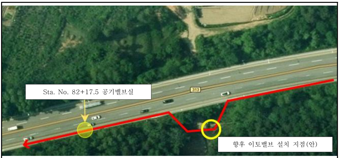
【그림 3.5】 이토밸브 추가 설치지점 (Sta. No. 82+17.6) 현황도
